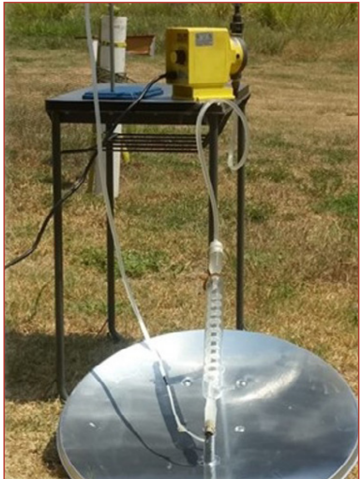
Imagen 7. Foto-reactor usado en la degradación de fenol. Evaluación fotocatalítica de AT en la degradación del 4-Cloro-fenol.
