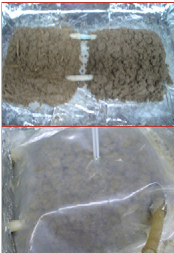
Imagen 3. Tratamiento de bagazo de caña y suelo contaminado a nivel laboratorio.
