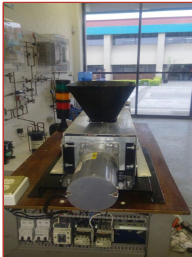
Figura 1. Extrusor construido por alumnos de la Universidad Tecnológica del Centro de Veracruz.
