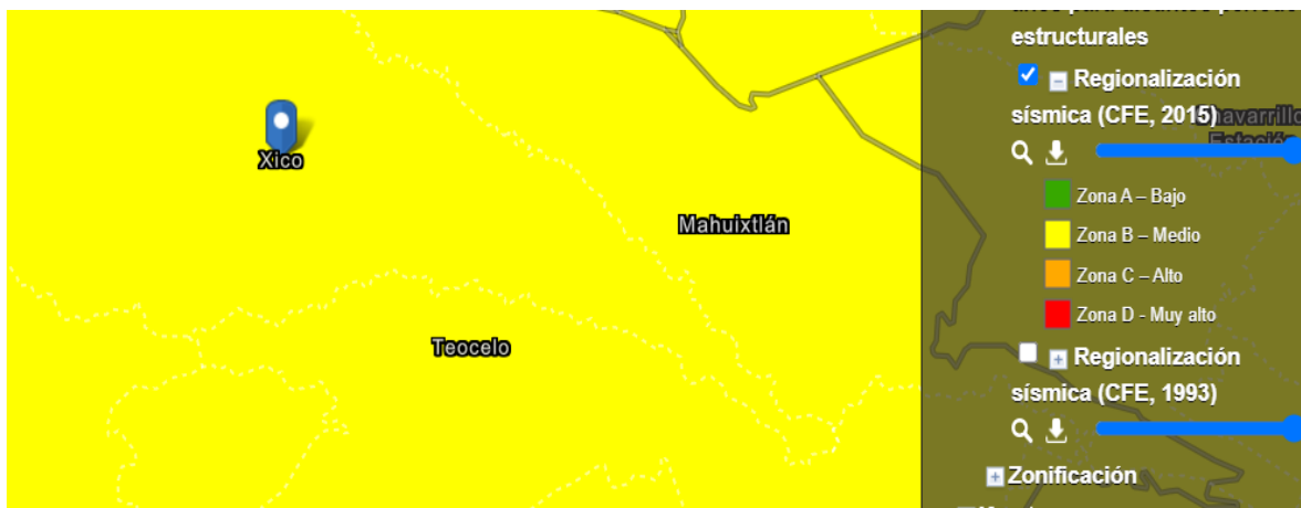
Figura 65 Regionalización sísmica en el municipio de Xico, Ver. Fuente: CFE, 2015; CENAPRED, 2022
